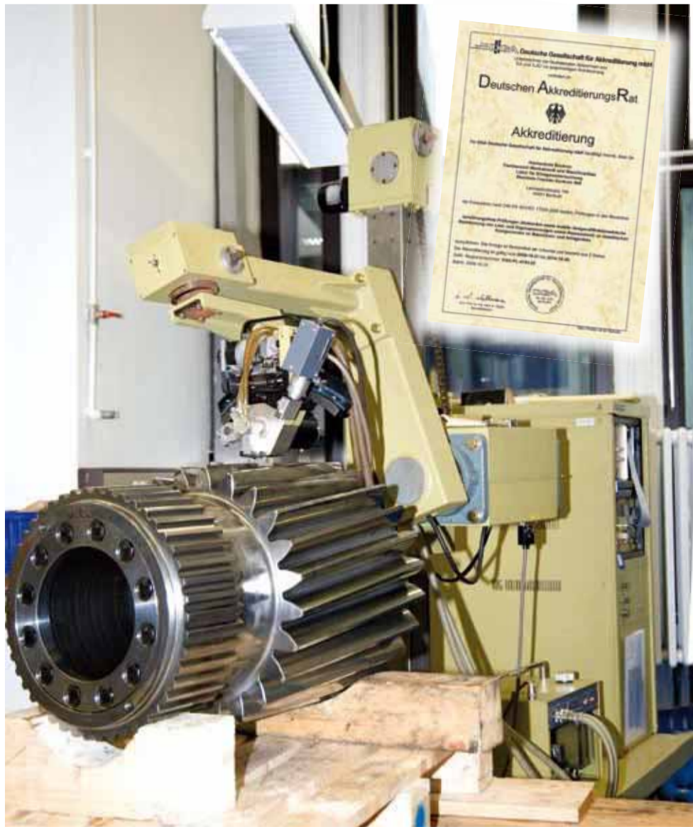
Materialprüfung mit dem Röntgendiffraktometer. Oben rechts die Akkreditierungsurkunde.
